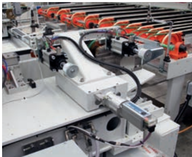
La regolazione automatica della linea di fede per asportazione in base allo spessore evita interventi manuali dell'operatore.
