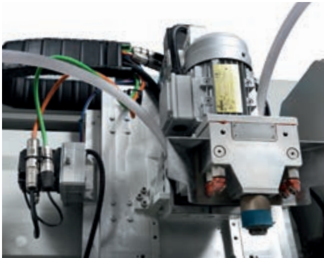
Facile accesso per la sostituzione delle mole tramite ribaltamento mandrino.
