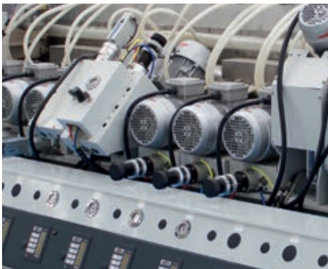
Le valvole proporzionali per gestione automatica pressione utensili lucidanti in base allo spessore riducono notevolmente i tempi di settaggio macchina.
